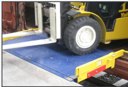
Protecciones contra descarrilamiento amarillas estándar para evitar que un montacargas salga del borde.
